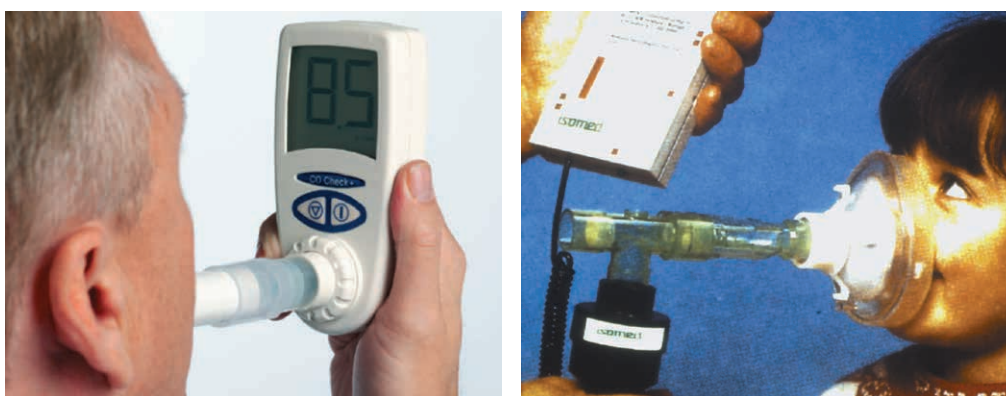
FIGURA 3. Muestra: recogida del aire espirado con mascarilla facial y boquilla desechable conectadas a un medidor portátil (reproducida de las instrucciones de uso del fabricante).
